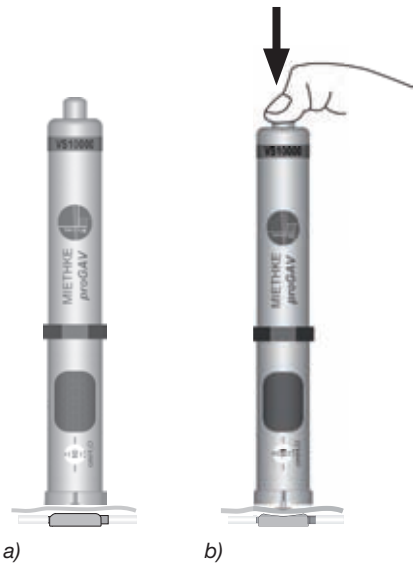
Abb. 17: Rotordrehung bei Verstellung a) falsche Richtung b) korrekte
