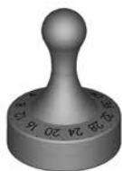
Fig. 19: giroscópio M.blue , cor: azul, níveis de pressão 0-40 cmH 2 O
