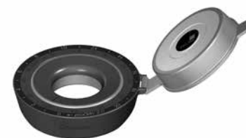
Fig. 15: regolazione dell'unità a pressione differenziale ( proGAV 2.0 ), nell'esempio illustrato su 1 cmH 2 O, o regolazione dell'unità a gravitazione ( M.blue ) (nell'esempio illustrato su 32 cmH 2 O).
