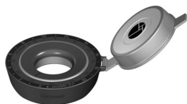
Afb. 14: Instellen van differentiaaldrukeenheid (proGAV 2.0) in voorbeeld op 1 cmH<sub>2</sub>O. of Instellen van gravitatie-eenheid (M.blue) in voorbeeld op 32 cmH<sub>2</sub>O.
