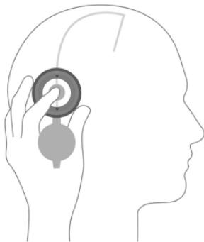
Fig. 6: Lokalisering af ventilen med M.blue plus Compass
