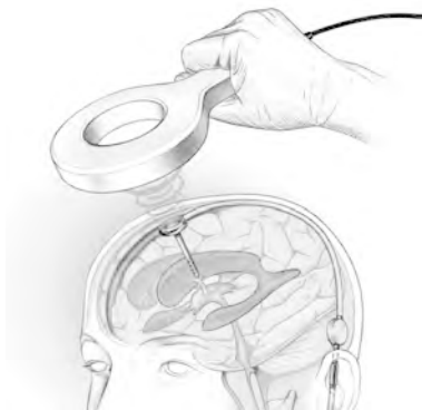
Fig. 2: La distance de travail pour la transmission de données téléométriques, c'est-à-dire la distance entre l'antenne et le M.scio est de 10 à 30 mm.
