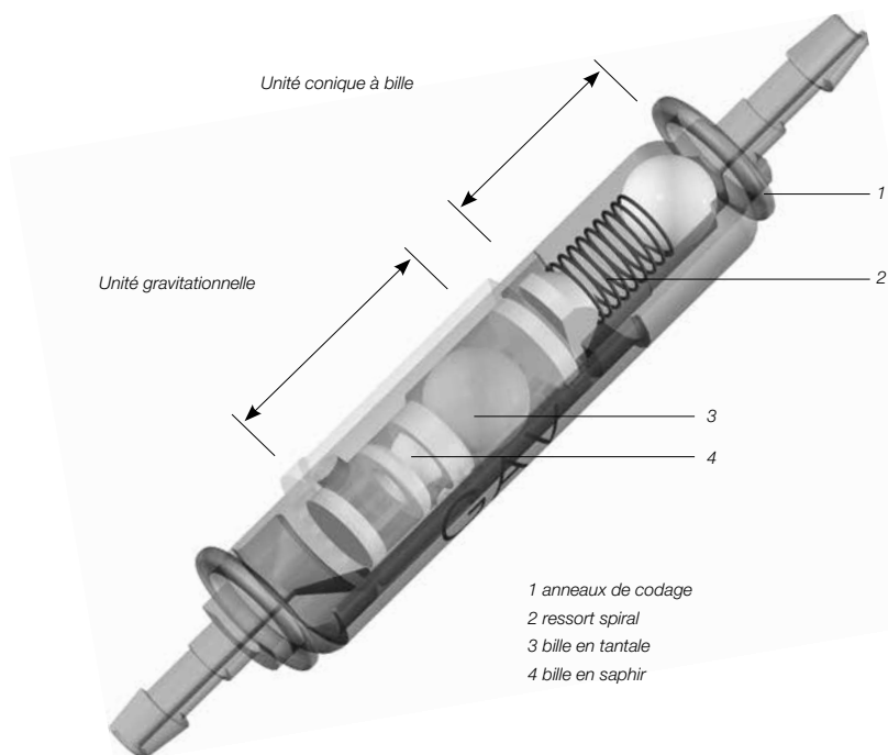
Fig. 1: présente un schéma en coupe de la valve GAV
