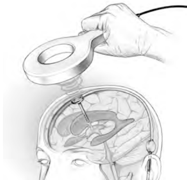
Abb. 1: Der Funktionsabstand der telemetrischen Datenübertragung, d.h. der Abstand zwischen der Antenne des Reader Unit Sets und dem M.scio beträgt idealerweise 10-30 mm.
