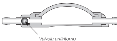
Fig. 2: CONTROL RESERVOIR con Valvola antiritorno
