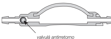
Fig. 2: CONTROL RESERVOIR con válvula antirretorno
