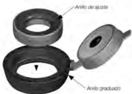
Figura 9: Colocación del anillo de ajuste
