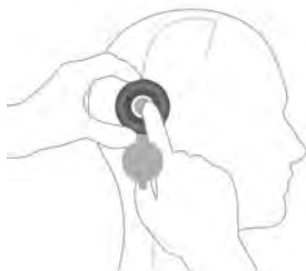
Figura 11: Regolazione con l'anello di regolazione M.blue plus
