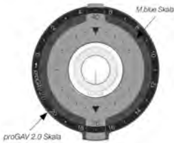
Abb. 8: Außen: Skala der Differenzdruckeinheit des proGAV 2.0 von 0 bis 20 cmH 2 O Innen: Skala der Gravitationseinheit des M.blue von 0 bis 40 cmH 2 O (Öffnungsdruck der Differenzdruckeinheit des proGAV 2.0 im Bildbeispiel 17 cmH 2 O, Öffnungsdruck der Gravitationseinheit des M.blue im Bildbeispiel 16 cmH 2 O)
