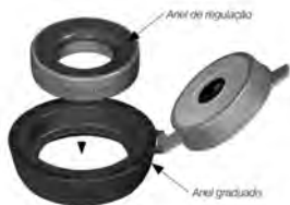
Figura 9: Inserimento dell'anello di regolazione
