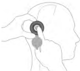
Abb. 11: Verstellung mit dem M.blue plus Verstellring
