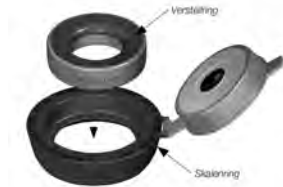
Abb. 9: Einsetzen des Verstellrings
