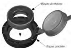
Figure 9: Mise en œuvre de la bague d'ajustage
