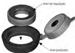
Figura 9: Colocação do anel de regulação
