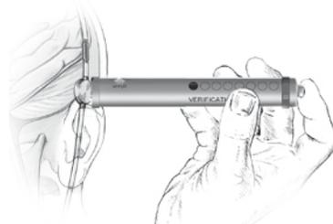
Abb. 13: Aufsetzen des Prüfinstruments
