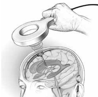
Fig. 2: misurazione della pressione con dispositivo di lettura per SENSOR RESERVOIR / SENSOR PRECHAMBER
