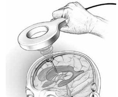
Illustr. 1: Den telemetriske dataoverføringens funksjonsavstand, dvs. avstanden mellom Antennen og SENSOR RESERVOIR / SENSOR PRECHAMBER måler 10-30 mm
