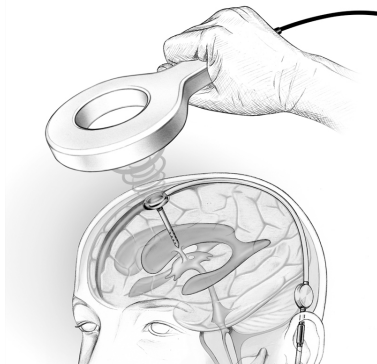
Afb. 1: De functionele afstand van de telemetrische gegevensoverdracht, d.w.z. de afstand tussen de antenne van de Reader Unit Set en de M.scio bedraagt idealiter 10 tot 30 mm.
