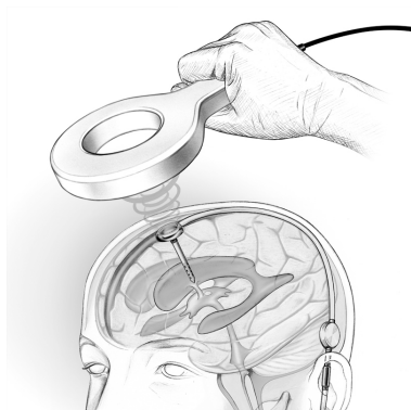
Illustr. 1: Optimal funksjonsavstand til den telemetriske dataoverføringen, dvs. avstanden mellom antennen til Reader Unit Set og M.scio er 10 til 30 mm.
