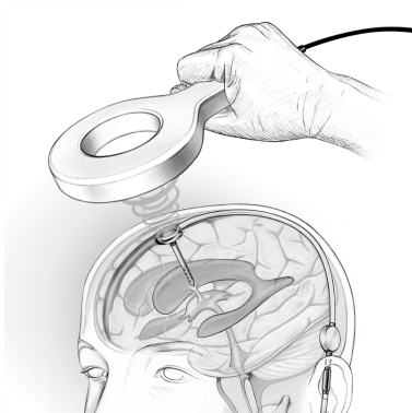
Ilustracija 1: Telemetrinių duomenų perdavimo funkcijos atstumas, t. y. atstumas tarp Reader Unit Set antenos ir M.scio idealiu atveju turi būti 10–30 mm.
