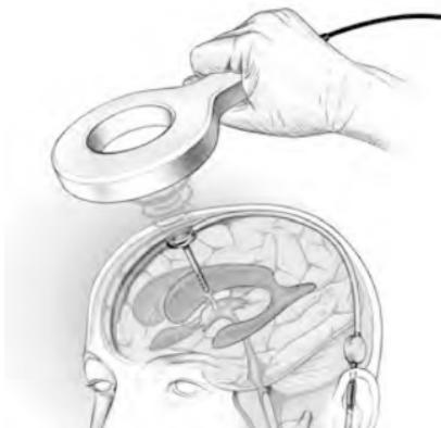
*Ábra 1: A telemetriktikus adatátvitel működési távolsága, vagyis a Reader Unit Set antennája és az *M.scio* közötti ideális távolság 10-30 mm.*
