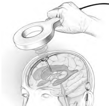
Rys. 1: Odstęp roboczy podczas telemetrycznego przesyłu danych, tzn. odstęp między anteną Reader Unit Set a M.scio wynosi w idealnej sytuacji 10-30 mm.
