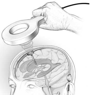
Fig. 2: Trykmåling med M.scio og Reader Unit Set
