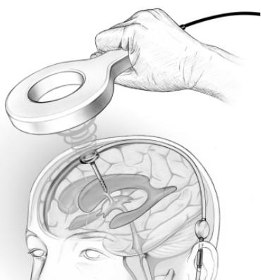
Obr. č. 2: Meranie tlaku pomocou zariadenia M.scio a Reader Unit Set
