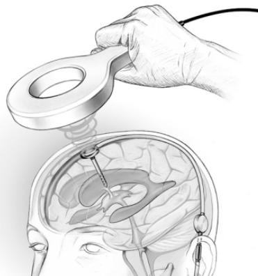
**Ábra 1:** A telemetrikus adatátvitel működési távolsága, vagyis a Reader Unit Set antennája és az M.scio közötti ideális távolság 10-30 mm.
