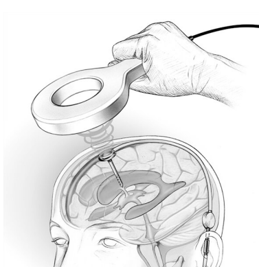
Εικόνα 1: Η λειτουργική απόσταση της τηλεμετρικής μετάδοσης δεδομένων, δηλ. η απόσταση μεταξύ της κεραίας του Reader Unit Set και του M.scio ανέρχεται ιδανικά σε 10-30 mm.
