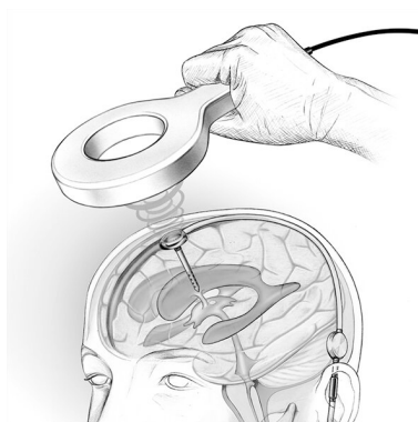
Фигура 1: Функционалното разстояние за телеметричното предаване на данни, т. е. разстоянието между антената на Reader Unit Set и M.scio , в идеалния случай е 10-30 mm.
