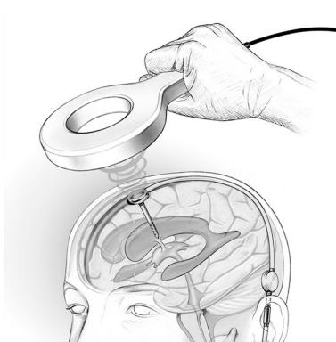
Obr. 1: Funkční vzdálenost telemetrického přenosu dat, tj. vzdálenost mezi anténou sady Reader Unit Set a M.scio je ideálně 10–30 mm.
