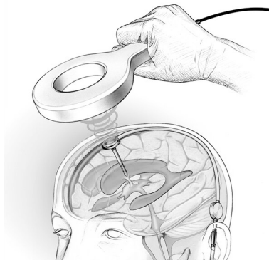
Illustr. 1: Optimal funksjonsavstand til den telemetriske dataoverføringen, dvs. avstanden mellom antennen til Reader Unit Set og M.scio er 10–30 mm.
