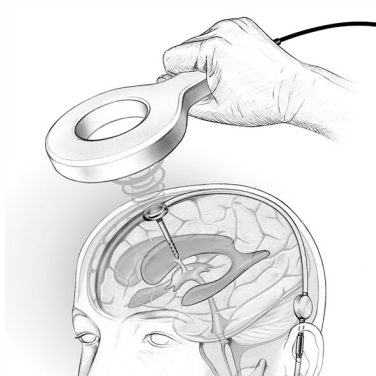
Joonis 1: Telemeetrilise andmete ülekandmise töökaugus, st Reader Unit Set -i antenni ja M.scio vaheline ideaalne kaugus on 10–30 mm.
