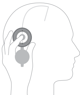
Obr. 9: Lokalizace ventilu pomocí M.blue plus kompas
