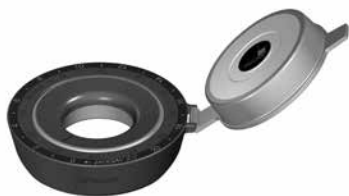
Obr. 13: Nastavení gravitační jednotky u zařízení M.blue (v příkladu obrázku na 32 cmH 2 O)
