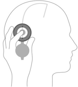
Fig. 9: Localizar la válvula mediante la M.blue plus Compass
