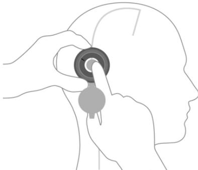
Abb. 14: Verstellung mit dem *M.blue plus Verstellung*
