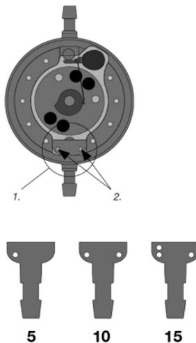
Abb. 6: Druckstufenkodierungen der Differenzdruckeinheit
