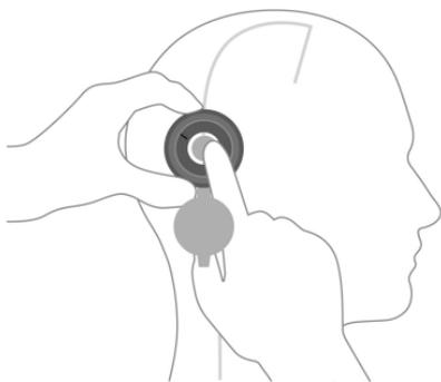
Fig. 14: Réglage par la *M.blue plus Adjustment Ring*
