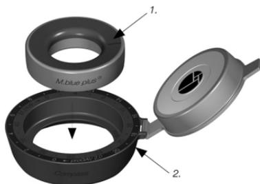
Abb. 12: Einsetzen des Verstellringes
