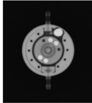
Fig. 5: Radiografia (unidade gravitacional regulável ajustada para 20 cmH<sub>2</sub>O; unidade de pressão diferencial: 5 cmH<sub>2</sub>O)
