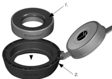
Fig. 12: Colocação do anel de regulação
