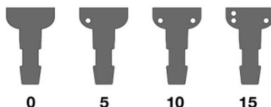
Fig. 6: Codifi ca dei livelli di pressione dell'unità a pressione differenziale
