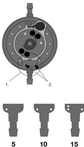
Fig. 6: Códigos de niveles de presión de la unidad de presión diferencial
