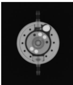
Fig. 5: Immagine radiologica (unità a gravitazione regolabile regolata su 20 cmH<sub>2</sub>O; unità a pressione differenziale: 5 cmH<sub>2</sub>O)
