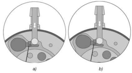
Fig. 3: Unidad gravitacional con el cuerpo en posición vertical a) cerrada b) abierta
