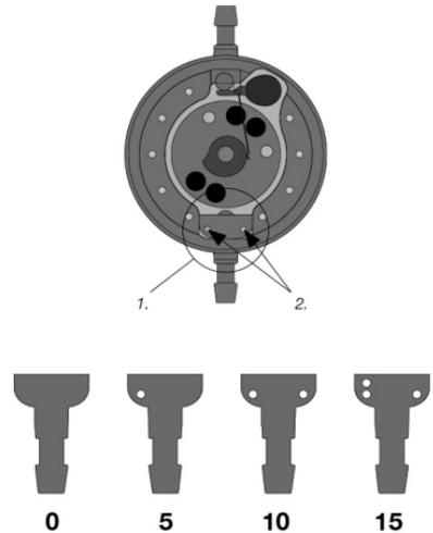
Fig. 6: Codificações de nível de pressão da unidade de pressão diferencial
