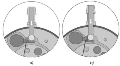
Abb. 3: Gravitationseinheit in vertikaler Körperposition
