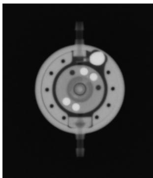
Fig. 5: Radiographie (unité gravitationnelle réglable, réglée sur 20 cmH<sub>2</sub>O; unité de pression différentielle: 5 cmH<sub>2</sub>O)
