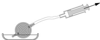
Fig. 19: Controllo dell'attraversabilità
