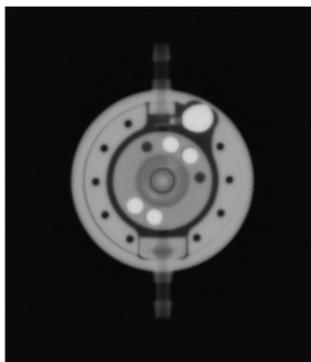
Abb. 5: Röntgenbild (verstellbare Gravitationseinheit eingestellt auf 20 cmH<sub>2</sub>O; Differenzdruckeinheit: 5 cmH<sub>2</sub>O)
