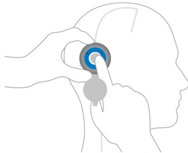
Abb. 18: Verstellung mit dem M.blue plus Verstellring
