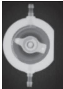
Fig. 18: Imagen radiográfica: la posición del rotor indica 0 cmH<sub>2</sub>O
