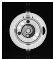
Fig. 6: imagem de raio X de uma unidade de pressão diferencial regulável, posição 14 cmH 2 O
