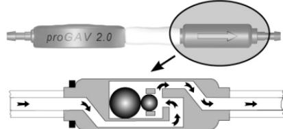
Fig. 2: unidade gravitacional com o corpo na posição horizontal
