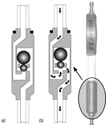
Fig. 4: Unidad gravitacional con el cuerpo en posición vertical
