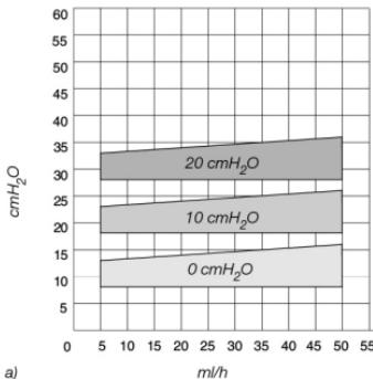
Fig. 19: Curvas características de presión-caudal de la proGAV 2.0 para los niveles de presión disponibles a) 10 cmH<sub>2</sub>O
