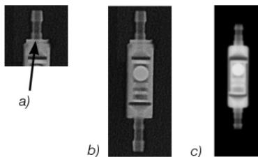
Fig. 7: Radiografía de la unidad gravitacional a) grande, 1 aro = 20 cmH<sub>2</sub>O, b) pequeño, sin aro = 10 cmH<sub>2</sub>O
