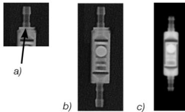
Fig. 7: imagem de raio X da unidade gravitacional a) grande, 1 anel = 20 cmH<sub>2</sub>O,
