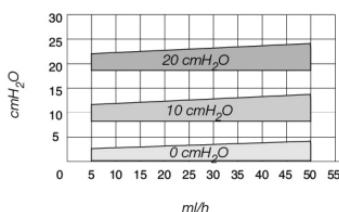
Fig. 18: Característica de pressão/fluxo para os níveis de pressão selecionados da unidade de pressão diferencial regulável
