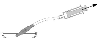
Fig. 16: Comprobación del paso de líquido
