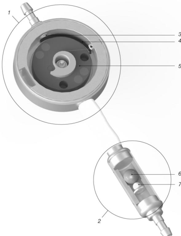
Fig. 1: proGAV 2.0 en sección transversal
