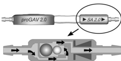
Fig. 2: Unité gravitationnelle en position horizontale du corps
