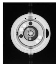
Abb. 6: Röntgenbild einer verstellbaren Differenzdruckeinheit, Stellung 14 cmH<sub>2</sub>O
