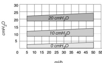
Abb. 17: Druck-Flow-Charakteristik für ausgewählte Druckstufen der verstellbaren Differenzdruckeinheit
