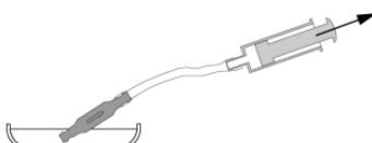
Fig. 15: Comprobación del paso de líquido
