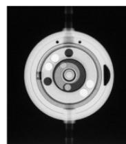
Fig. 6: Image radiographique d'unité à pression différentielle réglable 14 cmH<sub>2</sub>O
