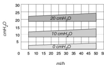
Fig. 17: Courbe pression/débit pour des niveaux de pression sélectionnés de l'unité à pression différentielle réglable
