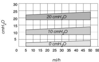
Fig. 17: caratteristica di pressione-flusso per livelli di pressione selezionati dell'unità a pressione differenziale regolabile
