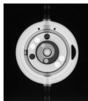
Fig. 6: Immagine radiologica di un'unità a pressione differenziale regolabile, posizione 14 cmH<sub>2</sub>O
