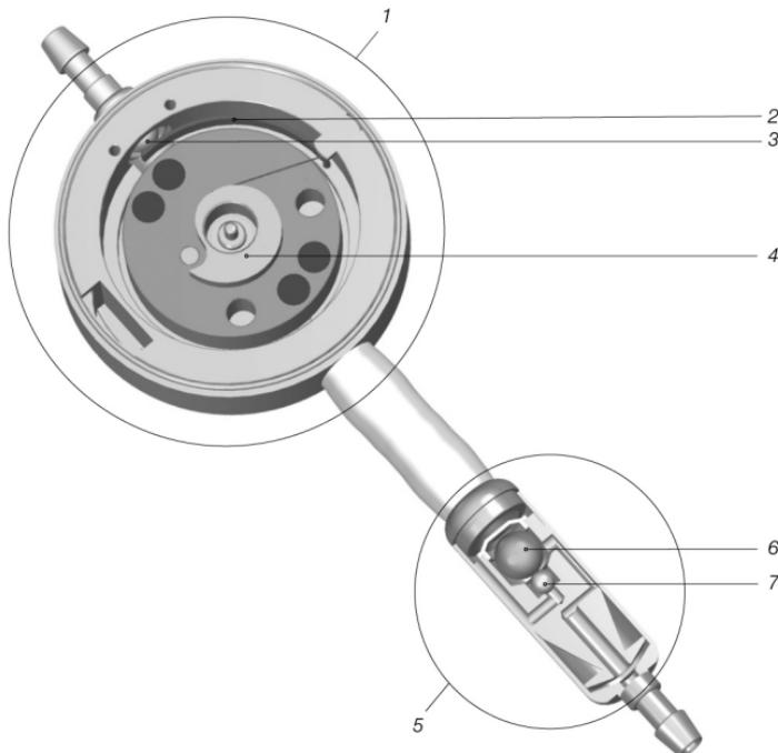
Abb. 1: proGAV 2.0 im Querschnitt
