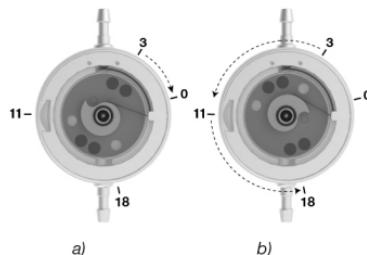
Fig. 12: Rotação do rotor durante a regulação
