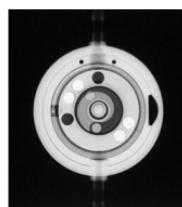
Fig. 6: Imagem de raio X de uma unidade de pressão diferencial regulável, posição 14 cmH<sub>2</sub>O
