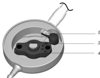
*Fig. 3: proSA avec unité gravitationnelle réglable en coupe*
