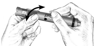
Abb. 28: Einstellung der gewünschten Druckstufe am Verstellinstrument
