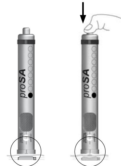
Fig. 11: Ajuste del nivel de presión
