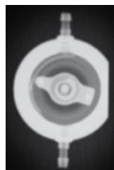
Abb. 19b: Röntgenbild verstellbare Differenzdruckeinheit: Stellung 0 cmH<sub>2</sub>O
