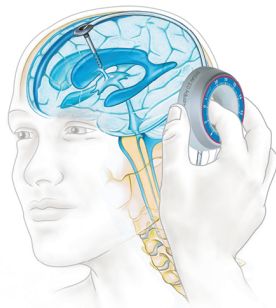
Fig. 13: Ajustage avec le proGAV 2.0 Adjustment Instrument
