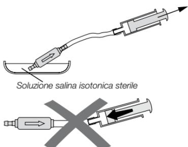
Fig. 6: Prova della pervietà
