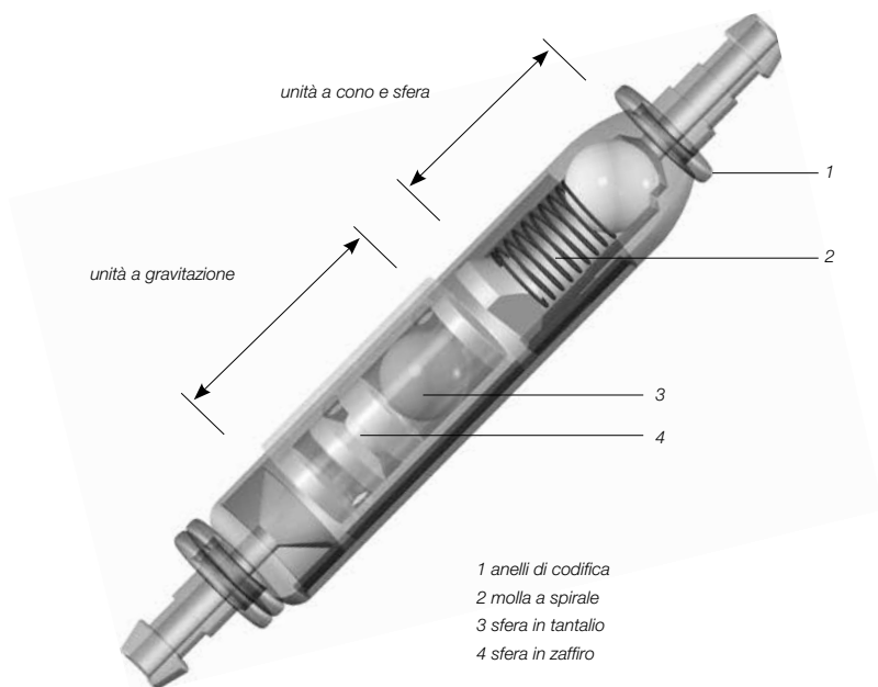
Fig. 1: Disegno schematico in sezione della paediGAV
