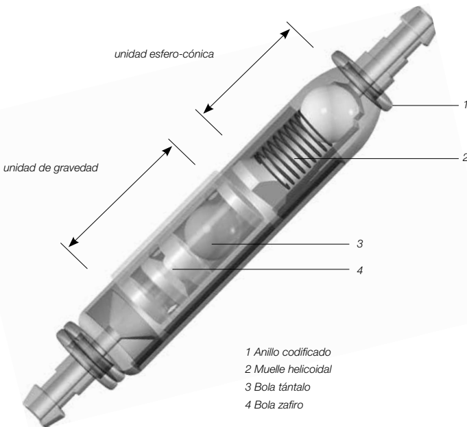
Fig. 1: paediGAV , sección transversal
