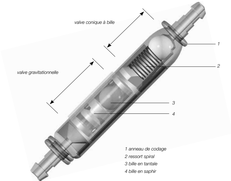
Fig. 1 Coupe schématisée de la valve paediGAV
