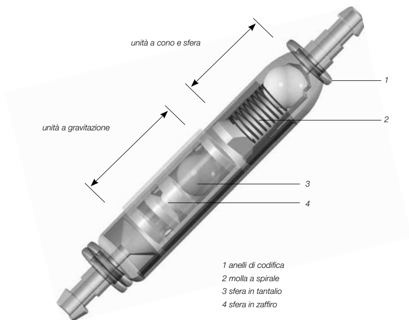
Fig. 1: Disegno schematico in sezione della paediGAV
