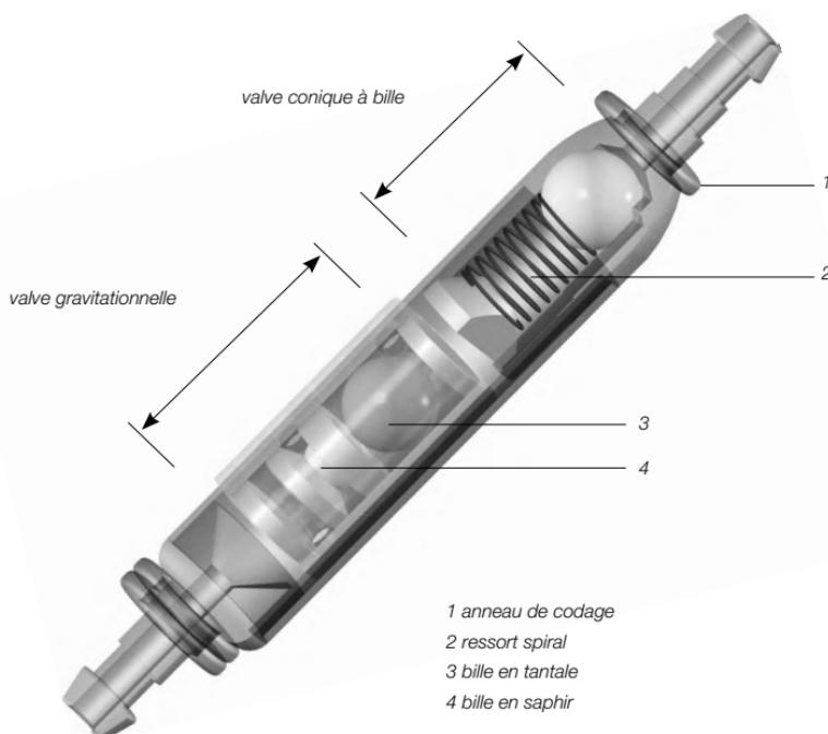
Fig. 1 Coupe schématisée de la valve paedigAV
