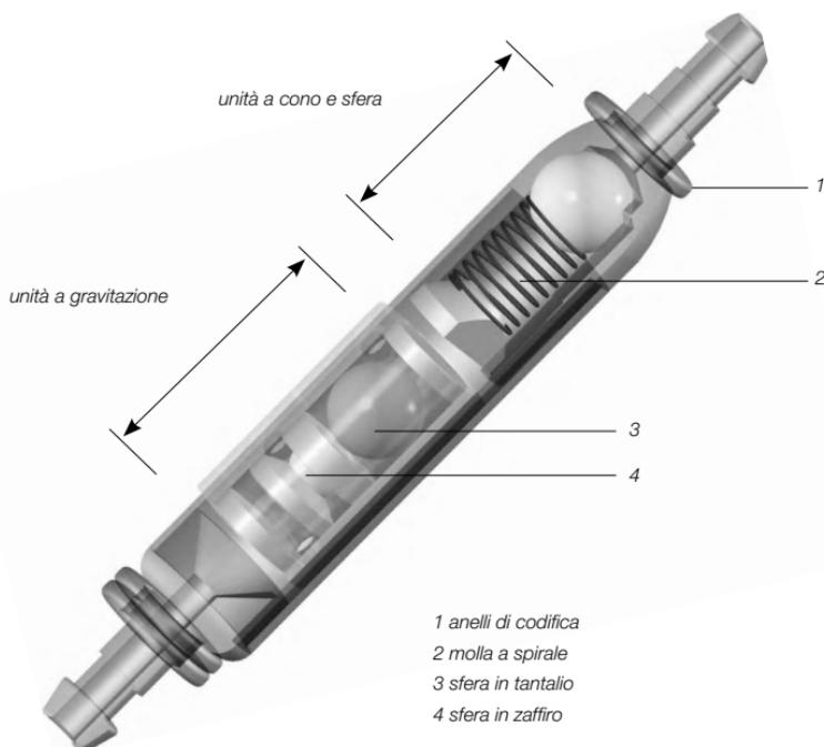
Fig. 1: Disegno schematico in sezione della paed/GAV
