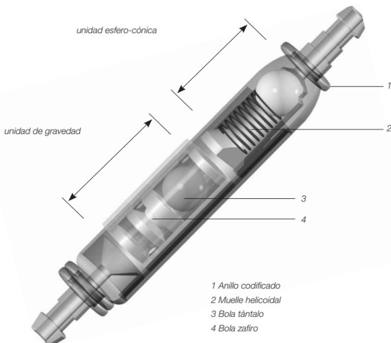
Fig. 1: *paediGAV*, sección transversal
