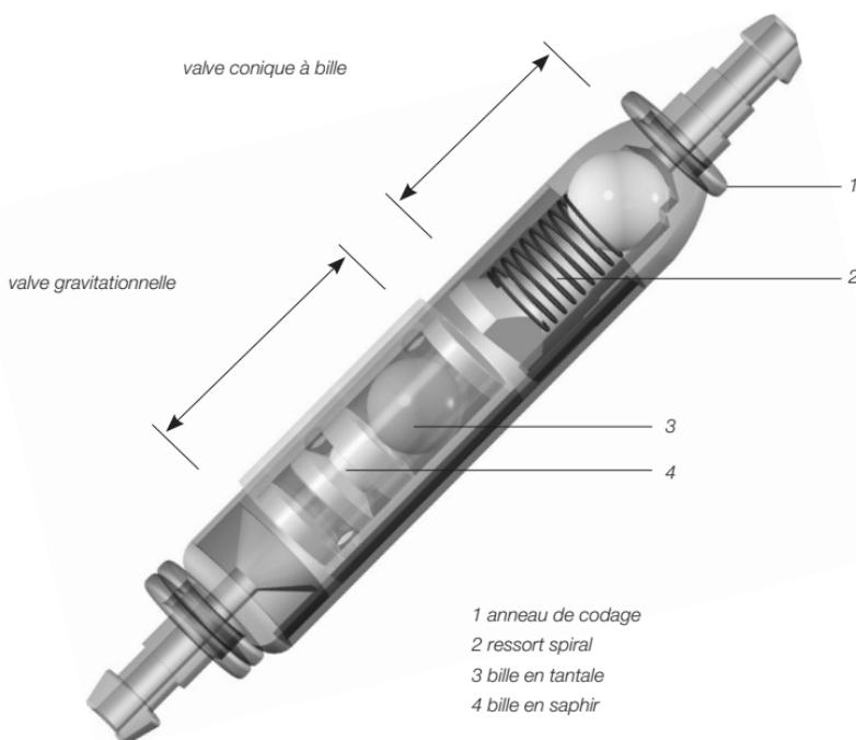
Fig. 1 Coupe schématisée de la valve paedIGAV
